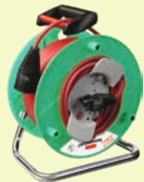
Kabeltrommel 25 m Geräte 13644 • Schutzklasse IP 44 • Verlängerungskabeltrommel mit Stecker und Kupplung • verzinktes Traggestell • Trommelkörper aus Kunststoff • Kabel: H05VV-F 3G1,5 - 25 m, Rot
