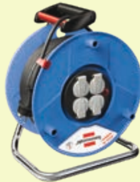
Kabeltrommel 50 m 13645 • 4 Schutzkontakt-Steckdosen mit selbstschließenden Deckeln • mit Überhitzungsschutz • Kontrollleuchte bei Überlastung und Überhitzung • verzinktes Traggestell • Trommelkörper aus Kunststoff • Kabel: H05VV-F 3G1,5 - 50 m
