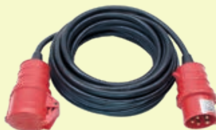
Verlängerungskabel 20 m 400 V 26118 • Schutzklasse IP 44 • für den Einsatz im Freien • Kabel mit CEE-Stecker 16 A und -Kupplung mit Verschlussklappe • Kabel: H05VV-F 5G1,5 - 20 m
