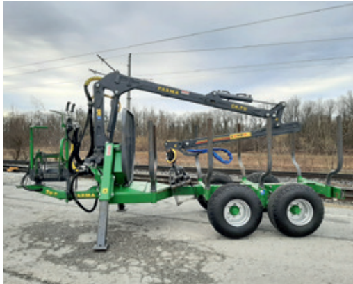
FARMA Forstanhänger T 9F mit Zapfwellenaufsteckpumpe, 4 Rungenpaare, Kreuzsteuer- hebel, 1 Achse gebremst, Knickdeichsel Lagerort: Bergheim
