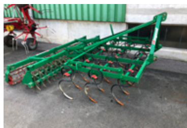
Regent Kultivator Regent Kultivator mit Krümmler und Sternwalze, 2,3 m breit, das Gerät befindet sich in einem guten Zustand Lagerort: Bergheim A. Kirchgatterer 0664/6271756 2.250,-
