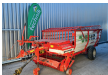
Pöttinger Ladewagen Trend junior 17 m³, Tieflader mit 10er Messerschneidwerk, WWGelenkwelle Lagerort: Bruck
