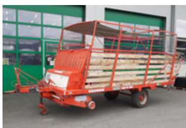
Gruber Ladewagen LH 1020 Hydr. gezogener Pickup. Mech. Kratzboden, mech. Heckklappe, Bereifung 10.0/75-15.3 Lagerort: Tamsweg
