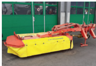
Pöttinger Mähwerk Novacat 225 Scheibenmähwerk mit Mittelaufhängung, 2,25 m Mähbreite, seitlich oder rückwärts hochklappbar, Klingenbox, Klingenschnellwechsel, Gelenkwelle Lagerort: Tamsweg A. Rieß 0664/2500644 2.890,-
