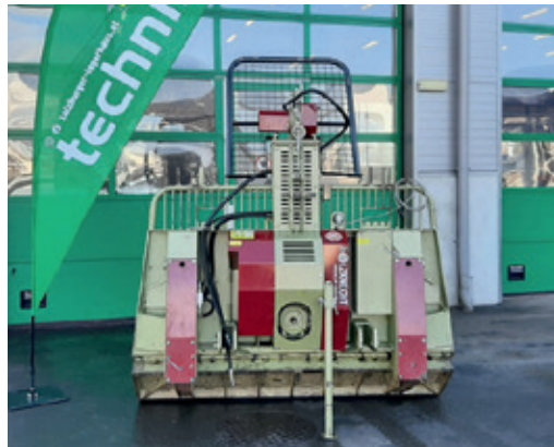
Holzknecht Seilwinde HS409K Bj.: 2020, Profi-Getriebewinde mit Proportionalbremse, 9 to konstante Zugkraft, hydraulisch über Funk verstellbarer Wickelturm, 2,2 m Schild- breite, mittig positionierter Zapfwellenstummel, Autec Profi-Forstfunk, hydraulisches Klappschild, Gelenkwelle, frisch servisiert Lagerort: Tamsweg
